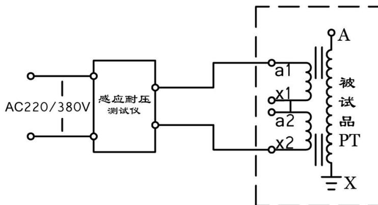
二次绕组串联加压原理图（附图二）
