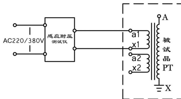
二次绕组加压原理图（附图一）
